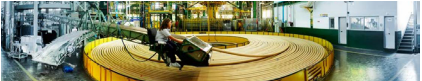
■ Produzione di cavi sottomarini Prysmian
